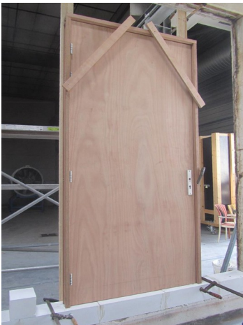
Foto 2 ; Deurblad in kozijn (vuurzijde)
